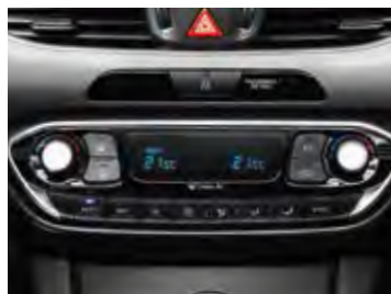
Automatski uređaj za klimatizaciju
