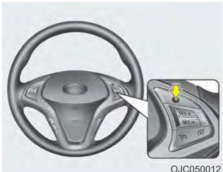
Svaka od ovi radnji isključiće sistem za regulisanje krstareće brzine vožnje (svetlo SET indikatora na instrument tabli će se isključiti), ali ovo neće isključiti sistem. Ako želite da potpuno isključite sistem, pritisnite dugme (RES+) koje se nalazi na kolu upravljača. Vratićete se na prethodno podešenu brzinu.
