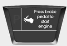
Ukoliko je dugme kontakt brave okrenuto u položaj ACC dva puta, i ako brzo pritisnete dugme bez pritiskanja pedale kočnice, indikator će svetleti 10 sekundi da ukaže da je potrebno da pritisnete pedalu kočnice da biste startovali motor.
