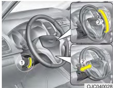
Da biste promenili nagib kola upravljača, pritisnite polugu (1) na dole da bi se odblokirala, podesite kolo upravljača u željeni položaj (2) i na željenu visinu (ako je vozilo opremljeno) (3) i zatim podignite polugu da fiksirate kolo upravljača. Podesite kolo upravljača pre početka vožnje.
