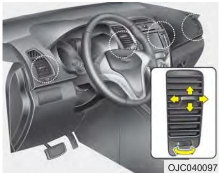
**Otvori za ventilaciju na instrument tabli**
