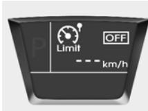
Ovaj indikator će svetleti na LCD ekratu kada je kontrolni sistem za ograničenje brzine uključen.
