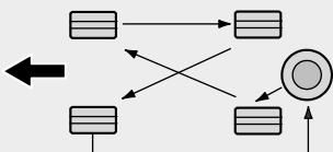
Bez rezervnog točka ili sa kompaktnim rezervnim točkom
