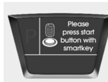
ukoliko pritisnete dugme kontakt brave dok indikator "Ključ nije detektovan" svetli, ovaj indikator će svetleti na ekranu oko 10 sekundi. Takođe, indikator immobilizatora će svetleti oko 10 sekundi.
