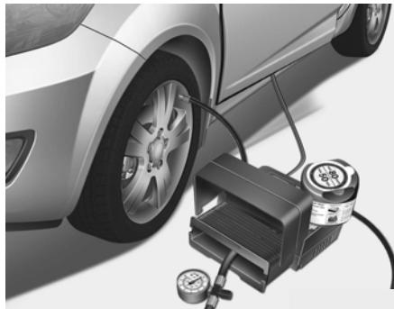
objektima i omogućava da ponovo napumpate pneumatik. Nakon što ste proverili da je dobro zakrpljen, možete voziti vozilo veoma oprezno do 200 km (120 milja) pri maksimalnoj brzini od 80 km/h (50 mph) dok ne dođete do najbližeg vulkanizera ili servisera radi zamene pneumatika.
