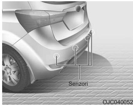
Sistem za pomoć prilikom vožnje unazad oglašava se zvučnim signalom ako senzori detektuju bilo kakvu prepreku na udaljenosti od 120 cm od vozila. To je samo pomoći sistem i ne zamenjuje pažnju vozača. Domet senzora kao i predmeti koje mogu senzori da detektuju su ograničeni. Kad god vozite unazad obratite pažnju na sve što se nalazi iza vozila, kao što biste uradili da vozite vozilo bez ovog sistema.
