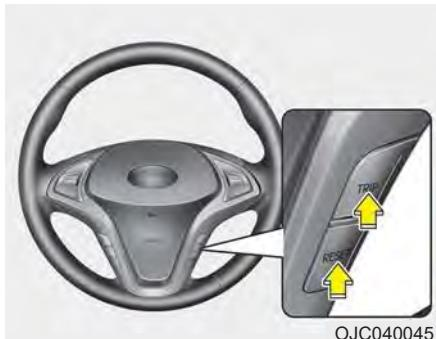
**Tripmetar (brojač dnevno pređene kilometraže)/Putni kompjuter (ako je vozilo opremljeno)**
