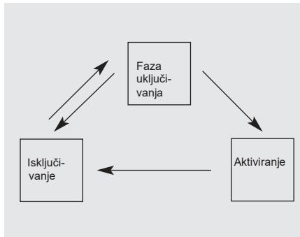
Ovaj sistem je napravljen sa ciljem da se obezbedi zaštitu od neovlaštenog ulaska u vozilo. Ovaj sistem radi u tri faze: prva faza je uključivanje, druga alarmiranje /aktiviranje, a treća isključivanje. Ako se aktivira, sistem obezbeđuje zvučni alarmni signal uz žmirkanje migavaca.
