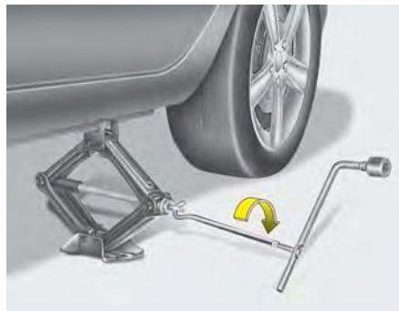
8. Ubacite ručku u dizalicu i okrećite je u smeru kretanja kazaljke na časovniku, podižući vozilo dok se točak ne odigne od zemlje otprije 30 mm (1.2 inča).
