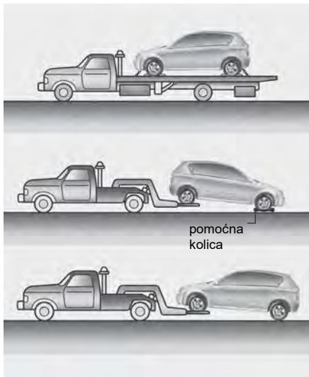
Vozilo možete vući sa zadnjim točkovima na zemlji (bez pomoćnih kolica) i prednjim točkovima odignutim od zemlje. Ako su točkovi koji se nalaze na zemlji ili komponente sistema oslanjanja oštećene ili ako vozilo vučete sa prednjim točkovima na zemlji, koristite pomoćna kolica, postavljajući ih ispod onog para točkova koji se nalaze na zemlji.
