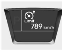
Podešena zadata brzina će biti prikazana kada je kontrolni prekidač za ograničenje brzine (SET-/ RES+) u položaju ON.
