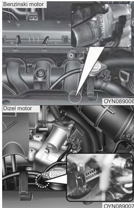
Broj motora utisnut je na bloku motora kao što je prikazano na slici.
