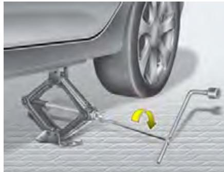
8. Ubacite ručku u dizalicu i obrćite je u smeru kretanja kazaljke na časovniku, podižući vozilo dok se točak ne odigne od zemlje otprije 30 mm.
