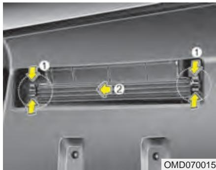
3. Izvadite kućište filtera pritiskom na reze koje se nalaze sa obe strane kućišta.
