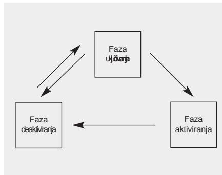
Ovaj sistem je napravljen sa ciljem da se obezbedi zaštitu od neovlašćenog ulaska u vozilo. Ovaj sistem radi u tri faze: prva faza je faza uključivanje, druga je faza alarmiranje / aktiviranje, a treća je faza je faza deaktiviranja/ isključivanje. Ako se aktivira, sistem obezbeđuje zvučni alarmni signal uz žmirkanje migavaca.
