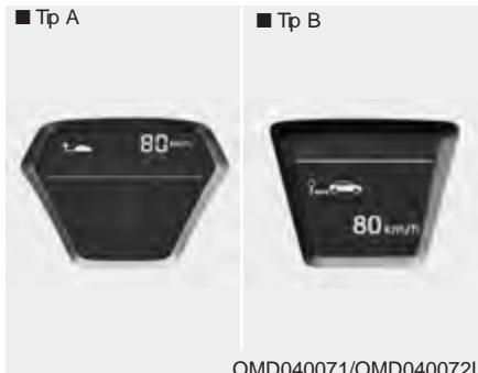
Prosečna brzina u (km/h ili MPH-milja na sat)
