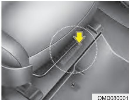
Identifikacioni broj vozila (VIN) se koristi za registraciju Vašeg vozila i u svim zakonskim regulativama koje se odnose na pravo vlasništva itd. Nalazi se na patosa vozila ispod suvozačevog sedišta. Da bi ste proverili broj, podignite rezan deo tepiha.
