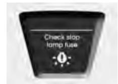
Ukoliko je prekidač stop svetla pregoreo, upozorenje na LCD ekranu će svetleti oko 10 sekundi. Zamenite osigurač novim, ukoliko je to nije moguće, motor ćete moći da pokrenete pritiskom na ENGINE START /STOP 10 sekundi u položaju ACC.
