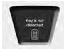
Ukoliko smart ključ nije u vozilu, pritisnute ENGINE START/STOP prekidač, upozorenje će se pojaviti na LCD ekranu, na oko 10 sekundi. Takođe i indikator immobilizatora svetli oko 10 sekundi.
