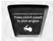
Ukoliko START /STOP prekidač prebacite u ACC položaj dva puta za redom bez otpuštanja papućice kvačila, svetlo upozorenja će se uplaiti na LCD ekranu na oko 10 sekundi, što će vam ukazati da je potrebno da otpustite pedalu kvačila da biste mogli da pokrenete motor.
