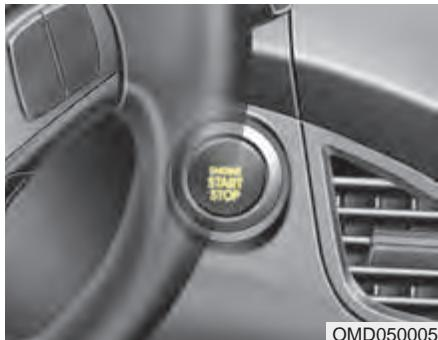
Osvetljeno dugme za pokretanje motora
