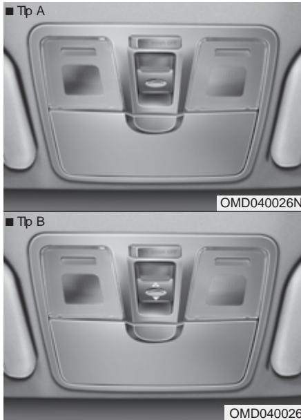
Ukoliko je vaše vozilo poseduje, krovni prozor, možete ga pomerati klizanjem ili izdizati pomoću kontrolnog dugmeta koje se nalazi na krovnom panelu, kada je kontakt ključ u ON položaju
