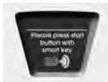
Ukoliko pritisnete ENGINE START/STOP prekidač, u toku upozorenja "Key is not detected" (ključ nije detektovan) na LCD ekranu će trepereti oko 10 sekundi upozorenje "Please press the start button with smart key" (pritisnite start prekidač sa smart ključem). Upozorenje za imobilizator će takođe trepereti oko 10 sekundi. t.
