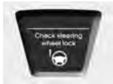
Ukoliko se kolo upravljača ne zadržava u uobičajeno, kada je ENGINE START/STOP prekidač u položaju OFF, upozorenje će na LCD ekranu svetleti oko 10 sekundi. Prateći zvuk upozorenja će se čuti oko 3 sekunde, i ENGINE START/STOP prekidač će trepereti oko 10 sekundi.
