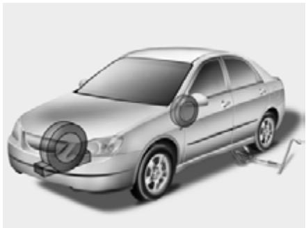
4. Izvadite ključ za odvijanje, dizalici, ručku dizalice i rezervni točak iz auta.
