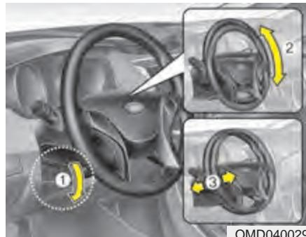
Da biste promenili nagib kola upravljača, povucite polugu (1) na dole da bi se odblokirala, podesite kolo upravljača u željeni položaj (2) i na željenu visinu (ako je vozilo opremljeno) (3) i zatim podignite polugu da fiksirate kolo upravljača. Podesite kolo upravljača pre početka vožnje.
