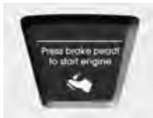
Ukoliko START /STOP prekidač prebacite u ACC položaj dva puta za redom bez otpuštanja papućice kočnice, svetlo upozorenja će se uplaiti na LCD ekranu na oko 10 sekundi, što će vam ukazati da je potrebno da otpustite pedalu kočnice da biste mogli da pokrenete motor.
