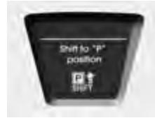
Ukoliko probate da ugasite motor bez prebacivanja menjača u P(Park) položaj, prekidač START/ STOP će se vratiti u položaj ACC. Ukoliko pritisnete ovaj prekidač još jedan put, prekidač će se prebaciti u ON položaj, a svetlo upozorenja će se uplaiti na LCD ekranu na oko 10 sekundi, što će vam ukazati na potrebu da menjač prebacite u P (Park) položaj. Ukoliko je vaše vozilo opremljeno ovom funkcijom,, takodje će se uključiti i zvuk upozorenja na oko 10 sek./ako je vozilo opremljeno)
