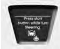
Ukoliko je volan ostao zaključan, kada ste pritisnuli START/ STOP prekidač, svetlo upozorenja će se upaliniti na LCD ekrani na 10 sekundi.
