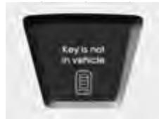
Ukoliko smart ključ nije u vozilu, i ako se neka od vrata otvore ili zatvore, a ENGINE START/STOP prekidač se se nalazi u položaju ACC, ON, ili START upozorenje na LCD ekrani će se pojaviti, takodje prateći zvuk upozorenja će se oglasiti na 5 sekundi, ukoliko smart ključ nije u vozilu a vrata budu zatvorena.
