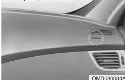
**Vozačev i suvozačev prednji vazdušni jastuk (Ako je vozilo opremljeno)**
