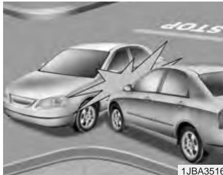
Prednji vazdušni jastuci se neće naduvati u bočnim sudarima, zato što se putnici u vozilu pomeraju u smeru udarca, iz tog razloga, u slučajevima bočnih sudara aktiviranje prednjih vazdušnih jastuka ne može da pruži dodatnu zaštitu putnicima. Međutim, bočni vazdušni jastuci i vazdušna zavesa mogu da se naduvaju u zavisnosti od inteziteta, brzine vozila i ugla udara.
