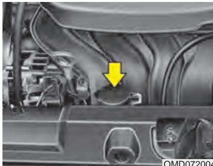
Proverite stanje i spojeve svih creva sistema za hlađenje i sistema za grejanje. Zamenite sva nabrekla i pohabana creva.
