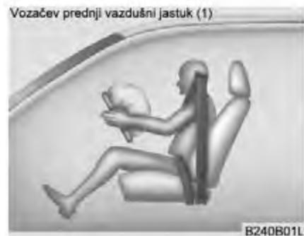
Moduli vazdušnih jastuka se nalaze i u centru kola upravljača i u prednjem panelu iznad kasete za sitnice kod suvozača. Kada SRSCM konstatiše jači udar na prednjem delu vozila, vazdušni jastuci se automatski naduvaju.
