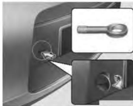
**Montažno/demontažna kuka za vuču (prednja)**
