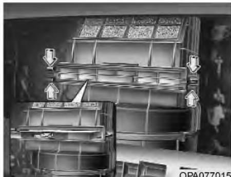
2. Uklonite poklopac filtera za vazduh klima uređaja povlačenjem obe strane poklopca.
