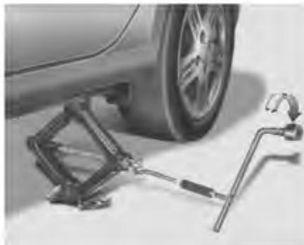
8. Ubacite ručku dizalice u dizalicu i okrećite je u smeru kretanja kazaljke na časovniku, podižući vozilo sve dok se točak ne podigne od zemlje. Ovo iznosi otprilike 30 mm (1.2 inča). Pre demontaže matica sa točkova, proverite da li je vozilo stabilno i da ne postoji mogućnost da se pomeri ili sklizne sa dizalice.
