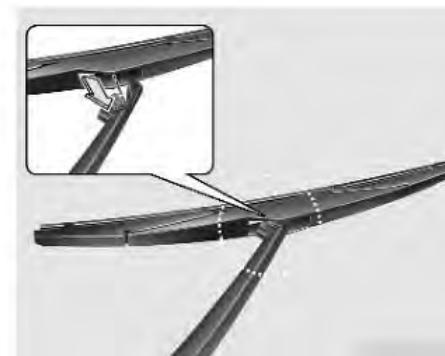
2. Postavite novu metlicu brisača tako što ćete ubaciti središnji deo u njeno ležište na ručici brisača dok ne čujete "klik" koji označava da je metlica "legla" na mesto.
